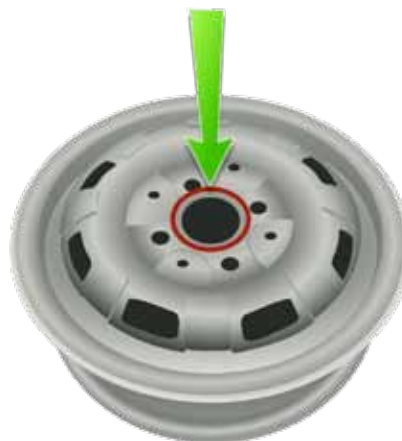
Furo da roda para eixo do carro.
